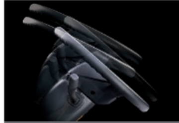
مقود قابل للإمالة والتقريب والتباعد ثم تزويد المقود بميزات التعديل عبر الإمالة أو عبر الشرب والتباعد مثل حركة التلسكوب
