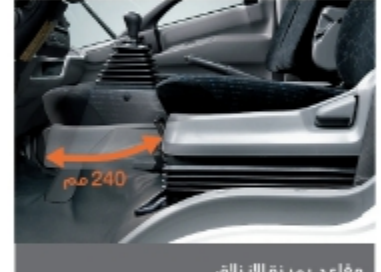
مقاعد بميزة الانزلاق ثم تثبيت قضبان المقاعد على منحني للمكين السائق من اختيار الوضعية المثالية
